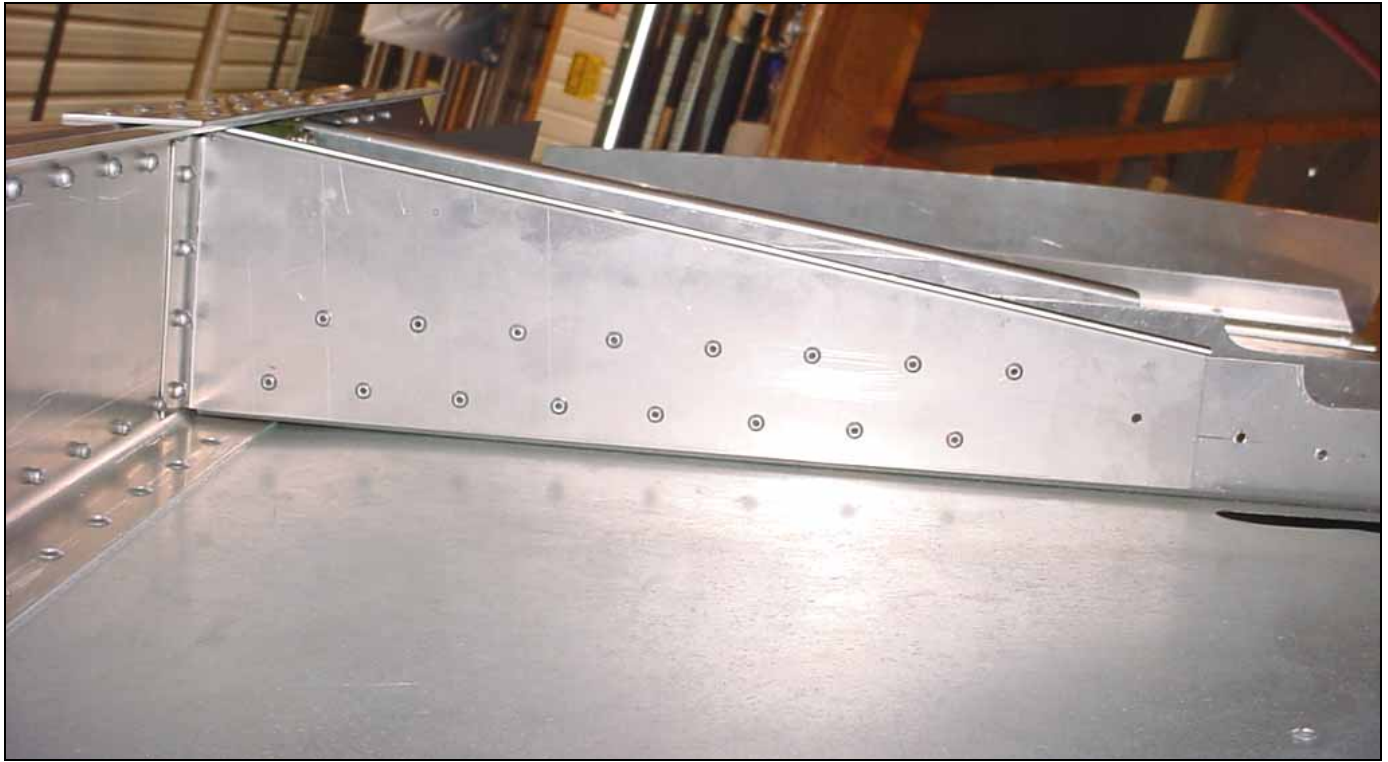
A5 PITCH 30 6B8-1 to 6B8-7 Edge distance 10mm from edge
