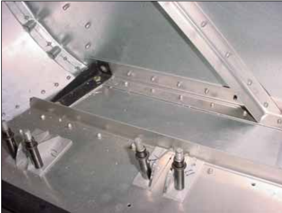
LOWER ENGINE MOUNT FITTING 6B6-5 Qty: 1L + 1R
